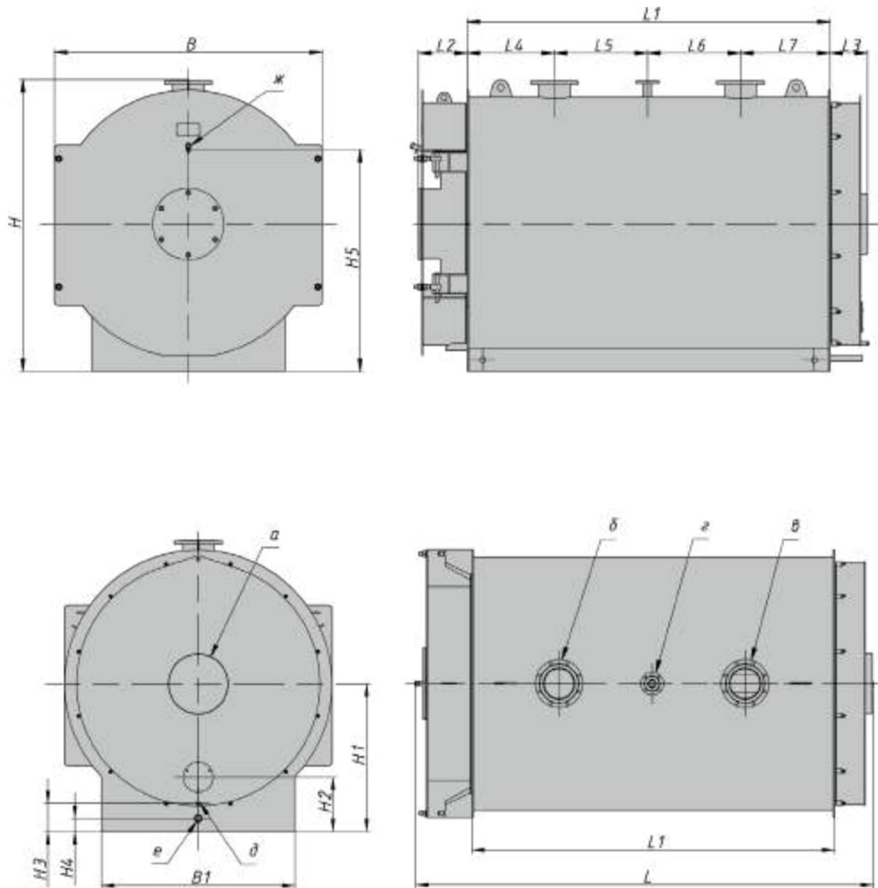
Таблица 3. Габаритные и присоединительные размеры котлов «GEYZER» 250-1250 кВт, (мм)
